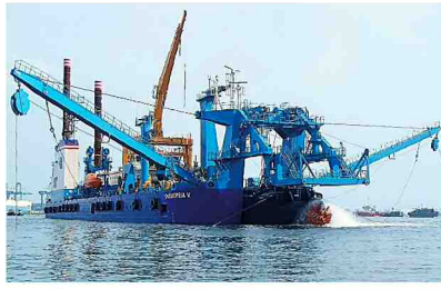
ポンプ浚渫船
